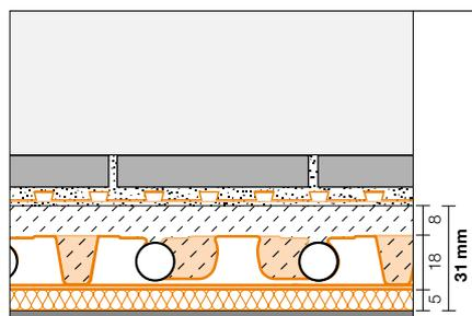
Schlüter-BEKOTEC-EN 18 FTS bietet mit einer eingebauten Trittschalldämmung einen besonders dünnen Heizestrich einen zusätzlichen Schallschutz bis zu 25 dB.
