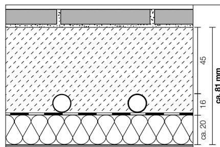
Die Norm verlangt eine Mindestüberdeckung der Heizrohre mit Estrich von 45 mm.
