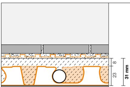
Schlüter-BEKOTEC-EN 23 F aus druckstabiler Tiefziehfolie wird direkt auf den Untergrund oder auf Dämmlagen verlegt.
