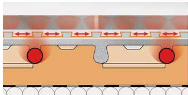
Der patentierte Aufbau des Klimabodens macht's möglich: Über miteinander verbundene Luftkanäle in der Schlüter-DITRA 25 Matte, unmittelbar unterhalb des Belags, verteilt sich die Heizungswärme besonders schnell und gleichmäßig und erwärmt den gesamten Fußboden in kurzer Zeit auf die gewünschte Temperatur.
