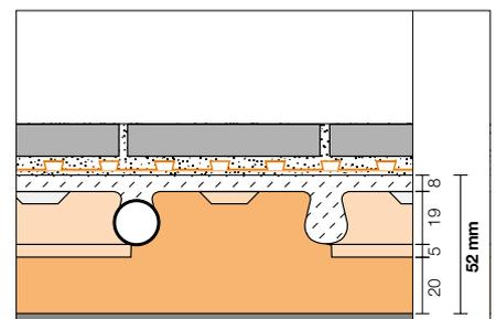
Das Schlüter-BEKOTEC System benötigt lediglich eine Überdeckung der Heizrohre von mindestens 8 mm, also weniger Aufbauhöhe und weniger Lasteintrag durch Estrichmasse.
